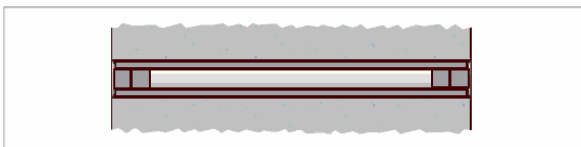
Uzávěr proti tlakové vodě a hluku dvěma zátkami z každé strany
