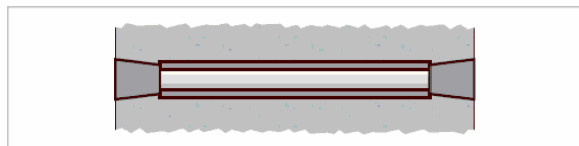
Uzávěr kónického otvoru proti vodě a hluku jedním vláknobetonovým kónusem délky 5 cm z každé strany
