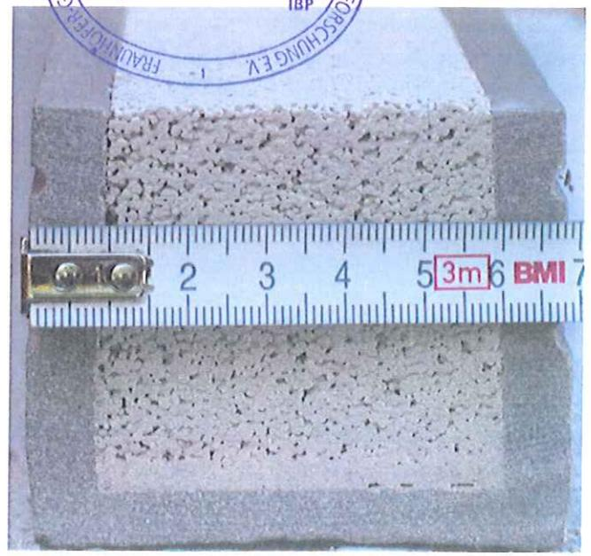
**Bild 1** Abbildung des Prüfaufbaus im Hallraum (oben) sowie Detailabbildungen der geprüften Abstandshalter Sorp 10<sup>®</sup> (unten); (Prüfobjekt S 10415-01).
