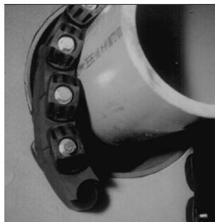
**2.** Verbinden Sie die beiden Enden der Kette. Lösen Sie die hintere Druckplatte nur soweit, dass sich der Dichtring frei bewegen lässt.
