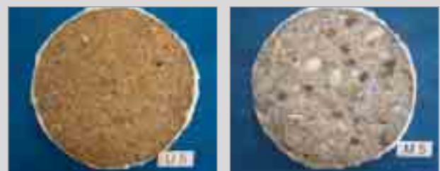
Bild 2: Unterschied zwischen den Betonkernen (links mit, rechts ohne Zemdrain®) nach 56 Frost-/Tauwechselln.
