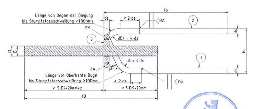
Pos 1 Schlaufenbügel mit Aufbiegung in die Platte
